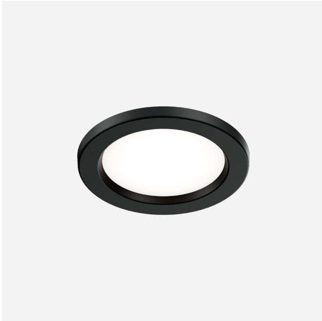
Plafonnier encastré rond en aluminium ; cache PMMA opale ; surface en Noir mat ; revêtement par poudre ; structure de surface mate ; RAL 9005 ; montage sans outil au moyen de ressorts à lames ; profondeur d'encastrement 50 mm ; PCB 3-step binning; couleur de lumière 3000 K ; binning initialement MacAdam  $\leq 3$  SDCM ; CRI  $\geq 90$  ; indice de protection IP44 ; Classe 3 ; source lumineuse peut être remplacée par Wever & Ducré ou par un professionnel avec une autorisation explicite ;
