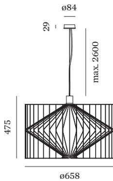
[2095E0B0] Les caractéristiques techniques sont des valeurs assignées pour une température ambiante de 25°C. Les données de flux lumineux sont soumises à une tolérance initiale de +/- 10%, celles de puissance électrique connectée à une tolérance initiale de +/- 10%, et celles de température de couleur initiale de +/- 150 kelvins. Nous déclinons toute responsabilité relativement à d'éventuelles erreurs d'impression. The general terms and conditions of Wever & Ducré BV apply.
