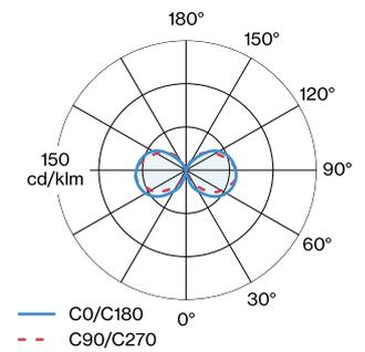
Luminaire suspendu sphérique ; abat-jour en acier peint ; culot E27 ; type de lampe A60 ; 220 - 240 V ; indice de protection IP20 ; Classe 1 ; sources lumineuses non incluses ;
